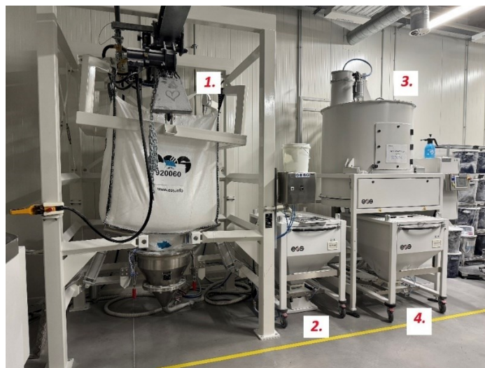
Obr.č.1.2 Systém míchání prášku od firmy EOS.
