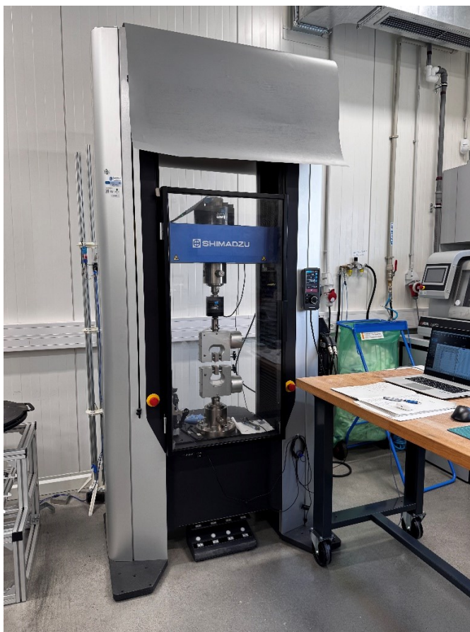
Obr.č.3.12 Zařízení pro tahovou zkoušku Shimadzu AGX-V
