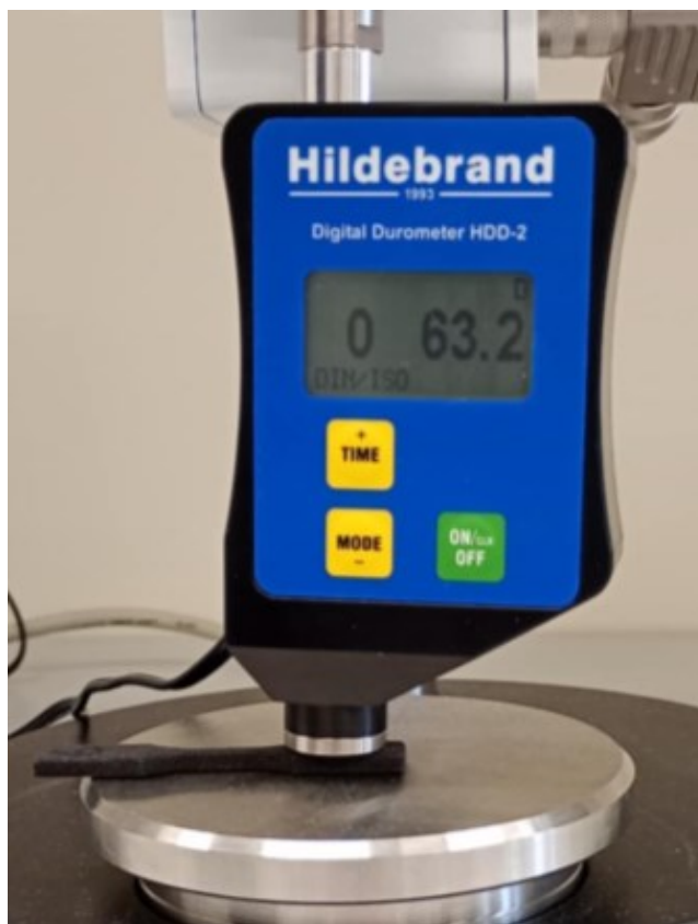
Obr.č.3.22 Tvrdoměr Hildebrand Digital Durometer HDD-2.
