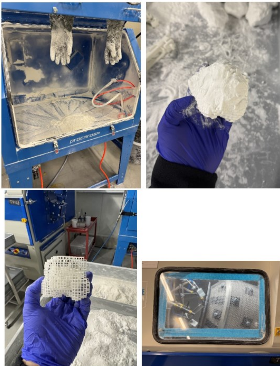
Obr.č.1.7: Zleva nahoře: pískovací komora s práškem, díl před otryskáním práškem, díl po otryskání práškem, automatická tryskací stanice s balotinou.
