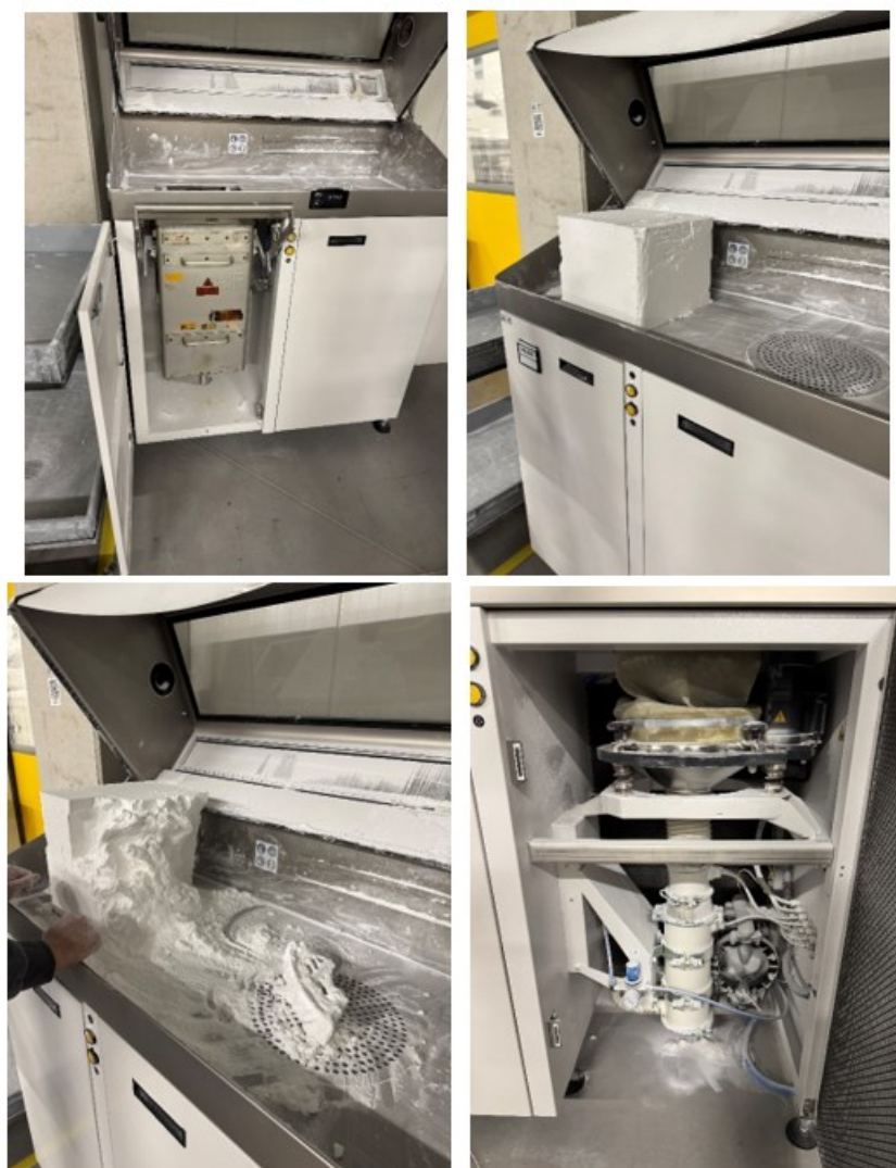
Obr. č.1.6: Zleva nahoře: kontejner v “odbalovací” stanici, vysouvání stavby, rozebírání stavby, prosévací soustava.
