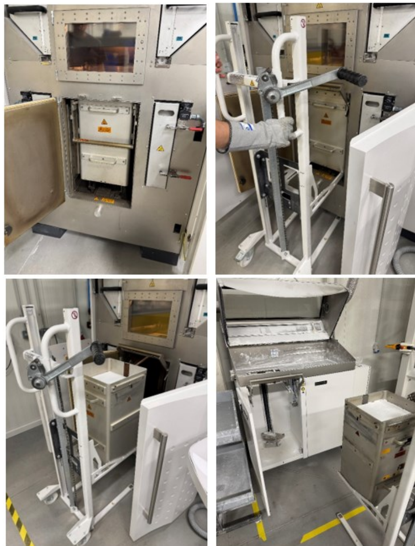
Obrázek č.1.5: Zleva nahoře: stavební kontejner uvnitř 3D tiskárny, vyjímání stavebního kontejneru, vyjmutý kontejner, vkládání kontejneru do “odbavovací” stanice.
