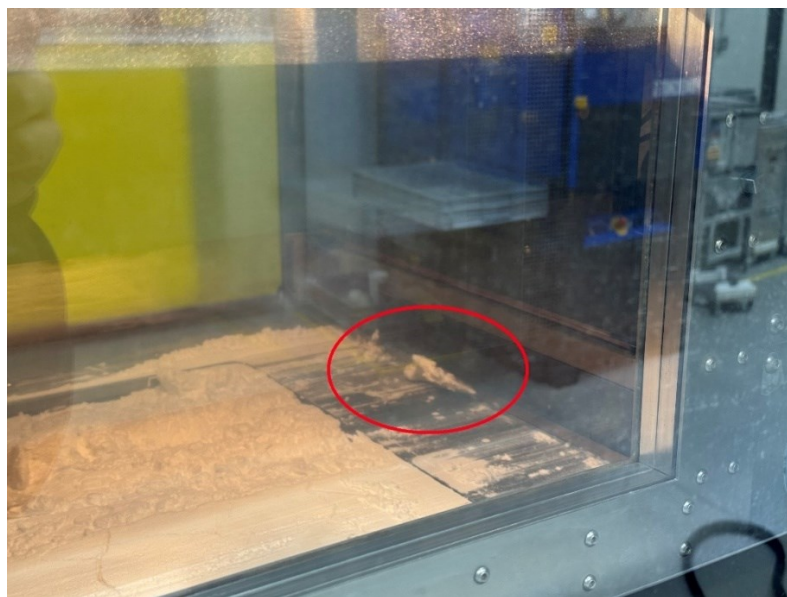
Obr.č.1.10 Nejčastější důvod havárie stavby – “napečenina” na recoateru.
